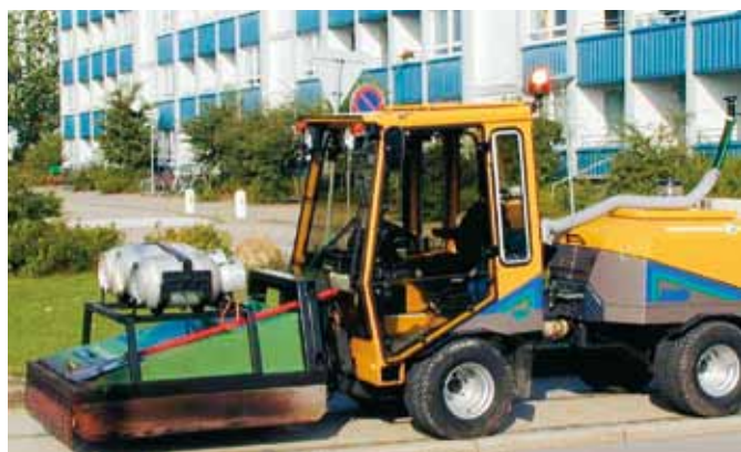
Pesticidfribekæmpelse af ukrudt med maskinmonteret ukrudtsbrænder.
